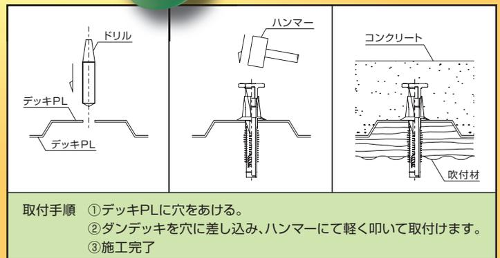
M18170 プラダンデッキ 結露防止インサート デッキ/断熱材敷込スラブ及び耐火被覆材吹付スラブ用
