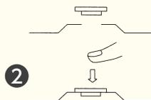
② デッキ穴にデッキ用止水ゴムパッキンSG-16を取り付ける。必ずパッキンの凸部を確実にデッキ穴に入れてください。
