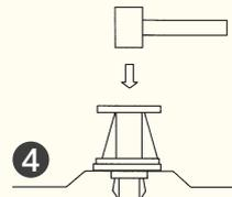
④ ハンマーにて金具頭部を叩き込み施工完了。
